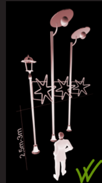
Dobro postavljen ukras! Ukrasi imaju vizualno bolji dekorativni efekt kada su u ravnini na svim stupovima i kada im donji dio nije postavljen previsoko.
