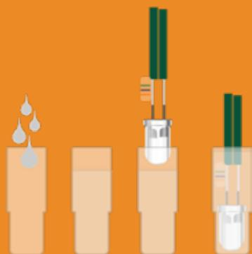
U PVC kapicu se brizga posebno 'epoxy' ljeplilo. Potom se u kapicu umeće LED dioda s otpornikom. Po sušenju silikona ledica je zaštićena do 1bara tlaka (do 30 min) od prodiranja vode u PVC kapicu i konektor. LED diodu nije moguće zamjeniti.
