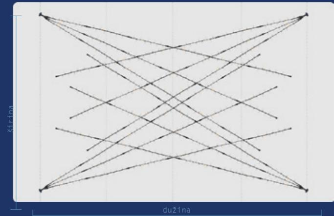
Model efektan za trgove. Iz simetričnih pozicija napaja se isti broj niti koje idu u različitim smjerovima. Niti su različitih dužina.
