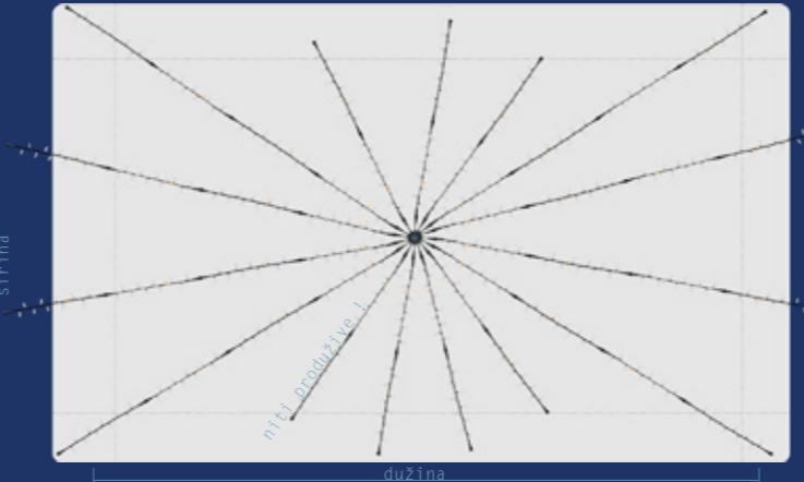
Model efektan za trgove sa centralnom instalacijom. Iz središnje pozicije napajaju se niti koje idu u različitim smjerovima kružno. Niti su različitih dužina.
