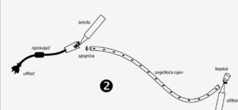
Svaki komad LED cijevi, nakon rezanja, potrebno je spojiti na priključni kabel s jedne strane, te na suprotnom kraju ugraditi zaštitnu kapicu! Za vanjsku upotrebu obavezno je korištenje brtvila u košuljici konektora i u završnoj kapici!
